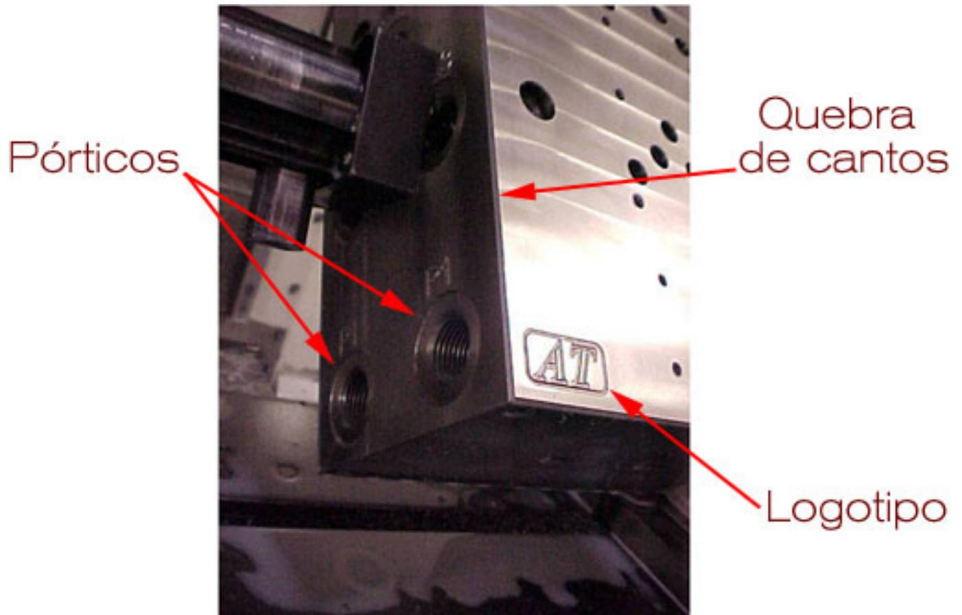
Finalizado a programação da máquina o bloco é posicionado no centro de usinagem onde serão executados todas as furações e alojamentos de válvulas em no mínimo de três faces, sendo portanto executado somente uma alteração de posição do bloco, garantindo assim a perfeita indexação, concentricidade, perpendicularismo e linearidade das medidas.
